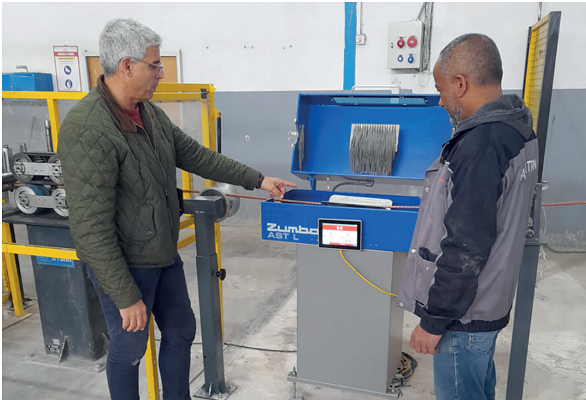
Sparktester AST bei Tunisie Cables
